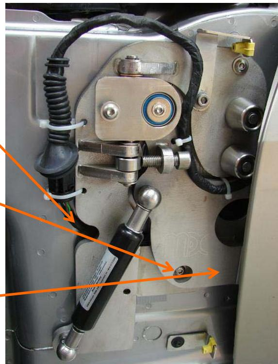
Das Kabel unter das Scharnier führen und in den Innenraum führen. Jetzt die untere Inbusschraube eindrehen.
